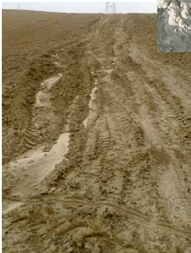
Fot. 2. Z lewej zastoiska wodne i spływy na zboczu pola powodujące erozję wywołane skrajnym i głębokim zagęszczeniem i odkształceniami plastycznymi profilu glebowego spowodowane wielokrotnymi przejazdami ciężkimi maszynami podczas modernizacji linii elektroenergetycznej w warunkach nadmiernego uwilgotnienia, z prawej odkrywka glebowa – działka 135, obręb Kierzkowo [nr 0017], powiat zniński Fot. T. Sobczyński
