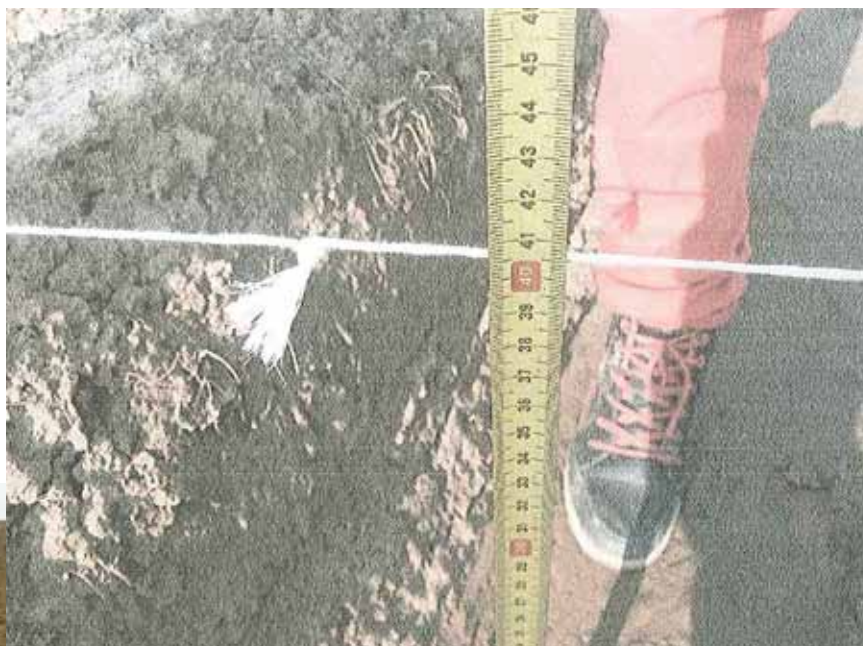
Fot. 3. Głębokie koleiny wskazujące na skrajne i głębokie zagęszczenie i odkształcenia plastyczne profilu glebowego spowodowane wielokrotnymi przejazdami ciężkimi maszynami podczas modernizacji linii elektroenergetycznej w warunkach nadmiernego uwilgotnienia zimą 2015 r. – obręb Wójcin [nr 0038], powiat zniński Fot. J. Rydlewski
