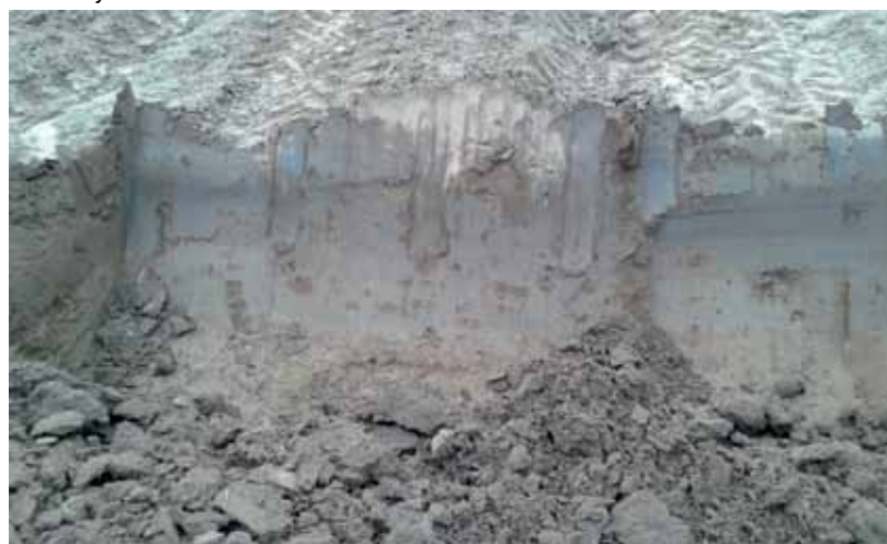
Fot. 2. Z lewej zastoiska wodne i spływy na zboczu pola powodujące erozję wywołane skrajnym i głębokim zagęszczeniem i odkształceniami plastycznymi profilu glebowego spowodowane wielokrotnymi przejazdami ciężkimi maszynami podczas modernizacji linii elektroenergetycznej w warunkach nadmiernego uwilgotnienia, z prawej odkrywka glebowa – działka 135, obręb Kierzkowo [nr 0017], powiat zniński Fot. T. Sobczyński
